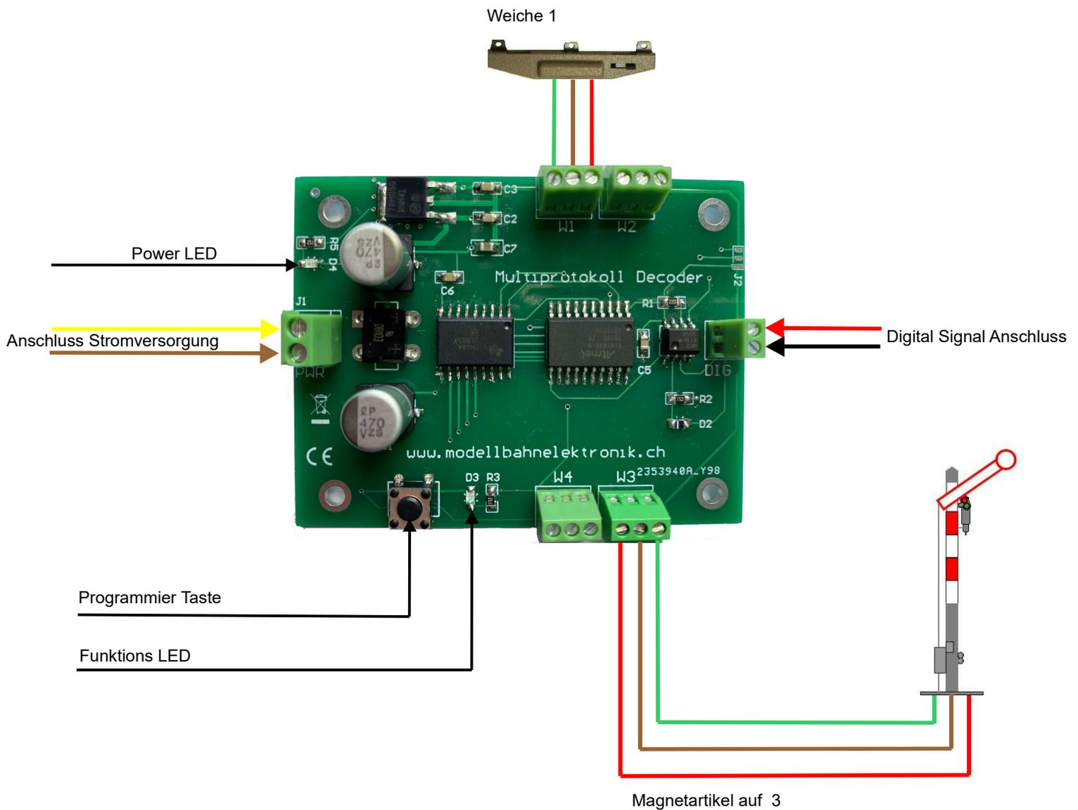
Die mittlere Anschlussklemme wird zum gemeinsamen Leiter des Weichenantrieb geführt (hier braun). Die Linke Anschlussklemme (grün) und Rechte (rot) Anschlussklemme wird zum Spulenanschluss geführt.
