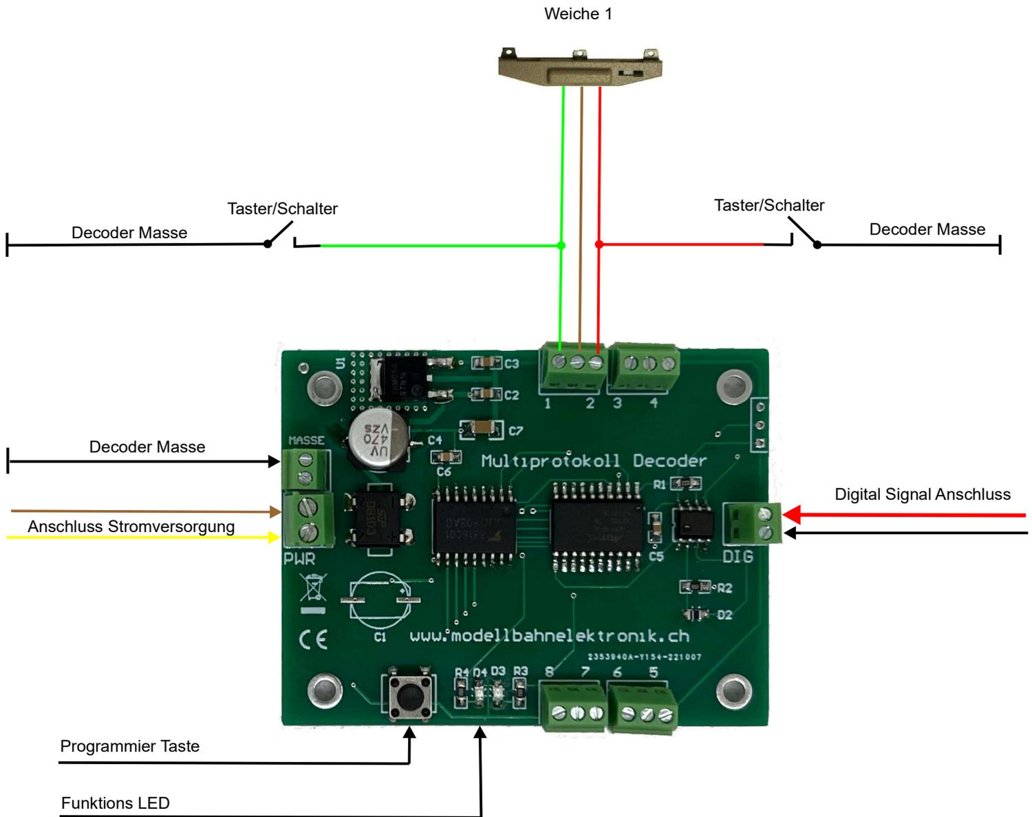
Die mittlere Anschlussklemme wird zum gemeinsamen Leiter des Weichenantrieb geführt (hier braun). Die Linke Anschlussklemme (grün) und Rechte (rot) Anschlussklemme wird zum Spulenanschluss geführt.
